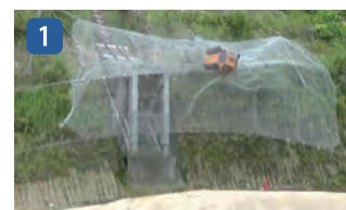
1 重錘を阻止面で受け止め、エネルギーを吸収
