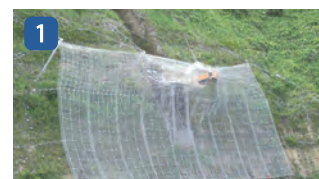
重錘を阻止面で受け止め、エネルギーを吸収
