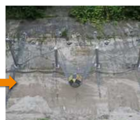
■ 重錘捕捉状況 (TYPE-S 鋼管支柱タイプ)
