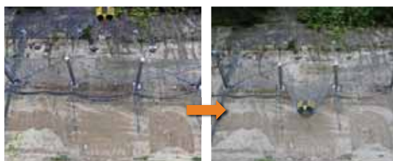
■ 重錘捕捉状況 (TYPE-S 鋼管支柱タイプ)
