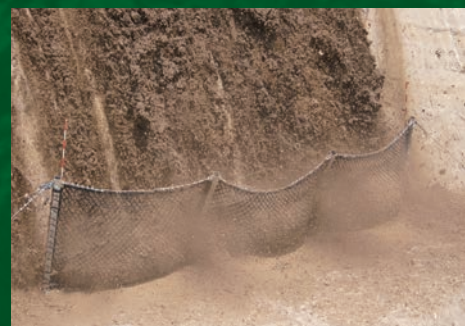
● 実規模実証実験 (崩壊土砂衝突実験)
