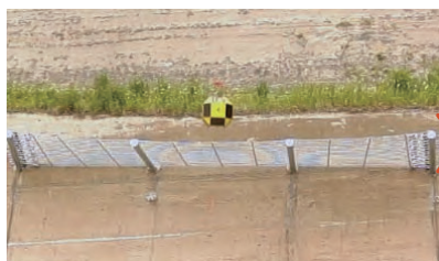
■ 1.6t重錘衝突状況
