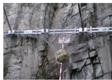
■ 実験状況 (重錘捕捉)
