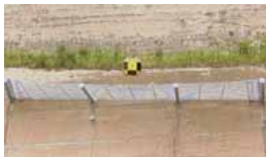
■ 1.6t重錘衝突状況
