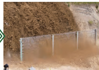
■ 実験状況 (実荷重の測定と防護効果の確認) 【金網4.0φ×50×50mm】
