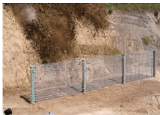
■ 実験状況 (実荷重の測定と防護効果の確認) 【金網4.0φ×50×50mm】
