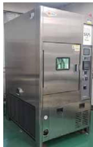
■ スーパーキセノンウェザーメーター試験機
