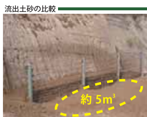
■ 捕捉状況 (標準金網使用時) 【金網4.0φ×50×50mm】
