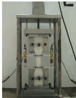
■ 一軸引張試験状況
