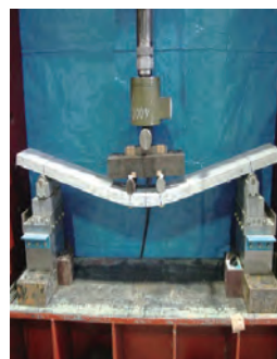
■ 曲げ試験状況
