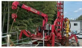
**P.52** モノレール搭載型クレーン付ダウンザホールハンマ削孔機
