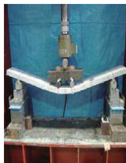
■ 曲げ試験状況
