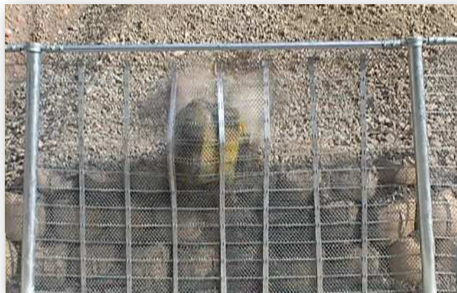
重錘 (質量 5.2t、直径 1.408m)
