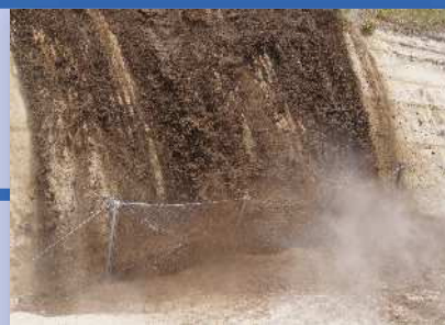
●崩壊土砂流下実規模実験状況
