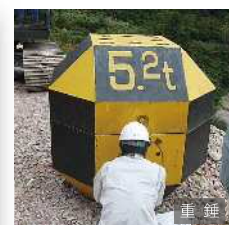
重錘 (質量 5.2t、直径 1.408m)
