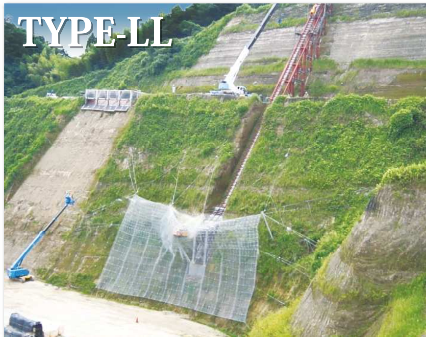
1 重錘を阻止面で受け止め、エネルギーを吸収
