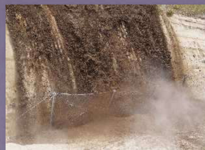
●土砂流下式による実規模実証実験
