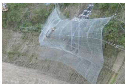
①重錘を阻止面で衝突し、エネルギーを吸収
