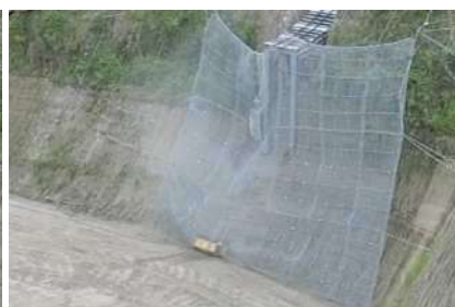
③金網から抜け出すことなく重錘を捕捉
