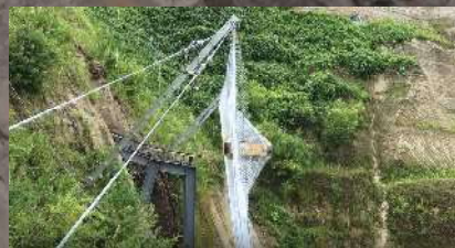
●斜面滑走式による実規模実証実験（平成30年）
