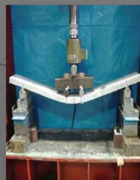
●曲げ試験状況
