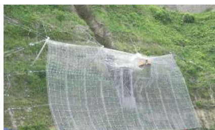
①重錘を阻止面で受け止め、エネルギーを吸収
