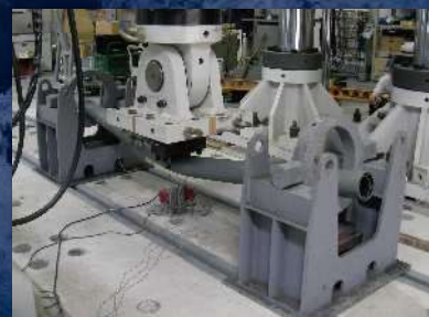
●支柱載荷状況
