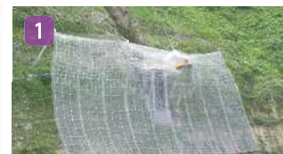
1 重錘を阻止面で受け止め、エネルギーを吸収
