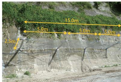
実験は実斜面の地盤上にアンカーを打設し供試体を構築しています。
