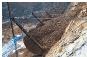
■ 実験状況（土砂捕捉後）
