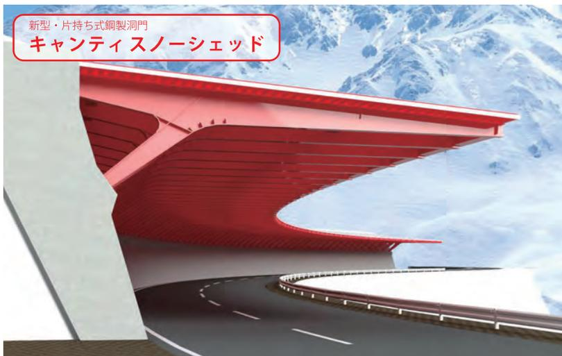
鋼製の主桁と山側下部構造を一体化した片持ち式スノーシェット
