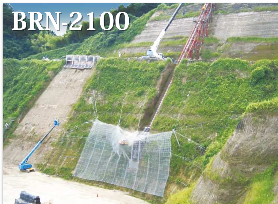
1 重錘を阻止面で受け止め、エネルギーを吸収
