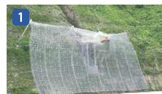
1 重錘を阻止面で受け止め、エネルギーを吸収
